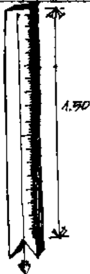
CATETE: REGLA GRADUADA CON PLOMO ESTE INSTRUMENTO DEBE SER PINTADO
