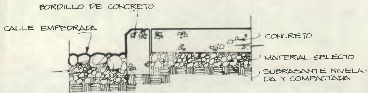
SECCION "C" ESCALA 1:10
