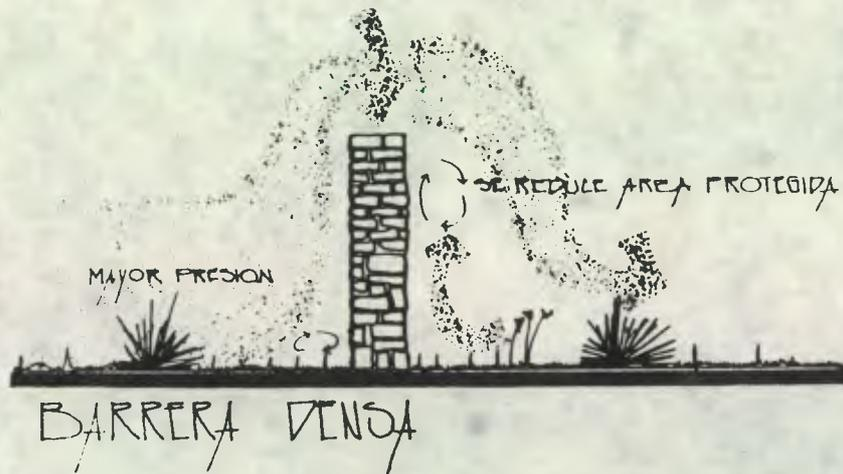
Su configuración como cinturón de protección depende del área a proteger, el cinturón no debe ser totalmente horizontal, ya que la velocidad se incrementa en el centro, debiéndose diseñar con determinada inclinación los extremos. (Ver gráfica No. 33)
