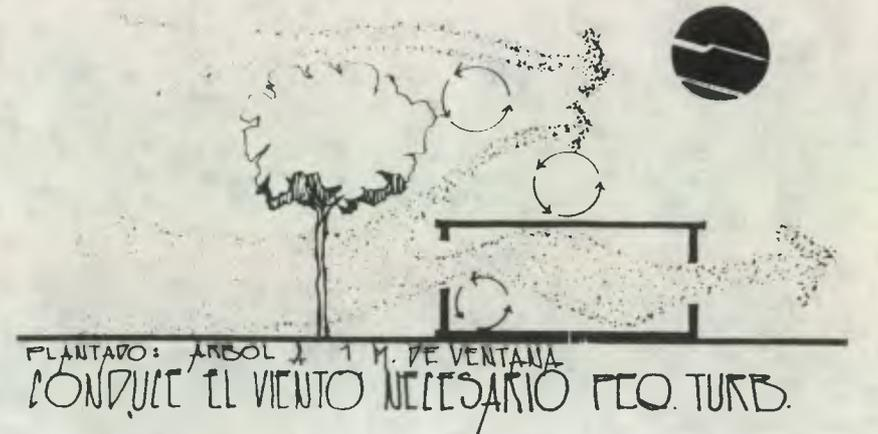
En las siguientes gráficas, se aprecia el efecto que produce los árboles de follaje denso, arbustos y ambos combinados a una distancia de 1 a 9 M de las ventanas y se observa como el viento se incrementa en la parte baja del tronco, entrando con flujo ascendente a la edificación, - sin embargo, siempre producirá turbulencia en el interior. (Ver gráficas No. 30)
