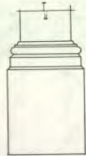
DETALLE BASE DE COLUMNAS INTERIORES ESC. 1:10
