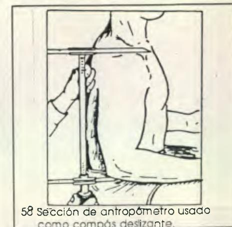
58 Sección de antropómetro usado como compás deslizante.
