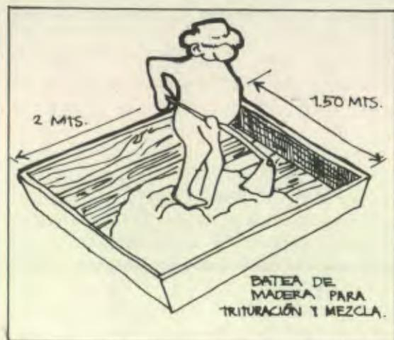
Después de triturar y mezclar el material debe guardarse en cargas equivalentes a la que se necesita por día de trabajo, envuelto en plástico para que se conserve húmedo y sea más uniforme y blando para trabajarse.
