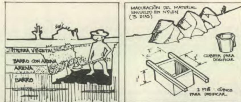
Una buena trituración y mezcla se refleja en la calidad de los materiales fabricados.
