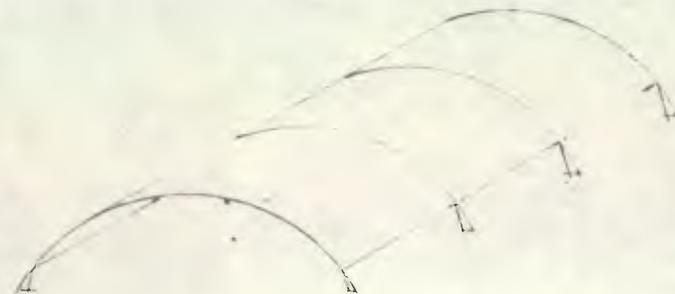
La lámina esférica absorbe las cargas básicamente por esfuerzos de tracción y compresión según paralelos. Dichos mecanismos actúan en una zona cuyo límite es el paralelo a  $52^\circ$  contados desde la clave (ver graf. 17a). Las perturbaciones de borde producen estados de flexión que se contrarrestan a través de un anillo (ver graf. 17b).
