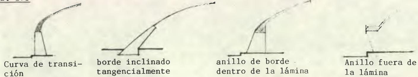
Finalmente, el paraboloides hiperbólico y el paraboloides elíptico en los que se dan acciones de arco y cable colgante (ver graf. 18). Para el paraboloides hiperbólico y elíptico es sumamente importante la rigidización de los bordes libres.
