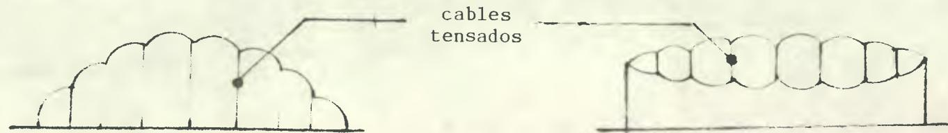
El sistema de tienda consiste en cables tensados que soportan a la membrana a la que estabilizan y rigidizan. Los cables se tienden sobre los elementos de apoyo que de acuerdo a los requerimientos pueden ser arcos, columnas u otro elemento. (Ver graf. 13).
