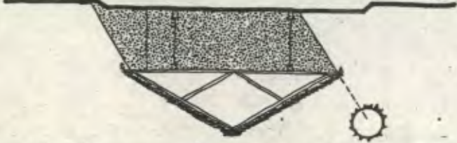
TECHO VOLADIZO VENTANAS REMETIDAS.
