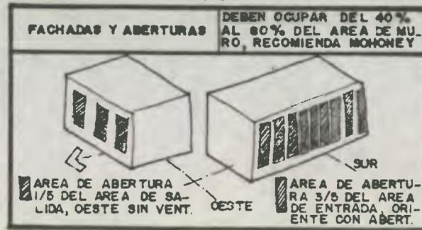
FACHADAS Y ABERTURAS, SUPERFICIE VITRIADA, NO DEBERA EXCEDER DEL 20% DE LA SUPERFICIE DEL MURO YA QUE EL VIDRIO PROVOCA UN CALENTAMIENTO EXCESIVO EN LOS INTERIORES. EL ANGULO DE INCIDENCIA DE LOS RAYOS SOLARES DEBERA SER MAYOR A 30° EN LAS SUPERFICIES VITRIADAS.
