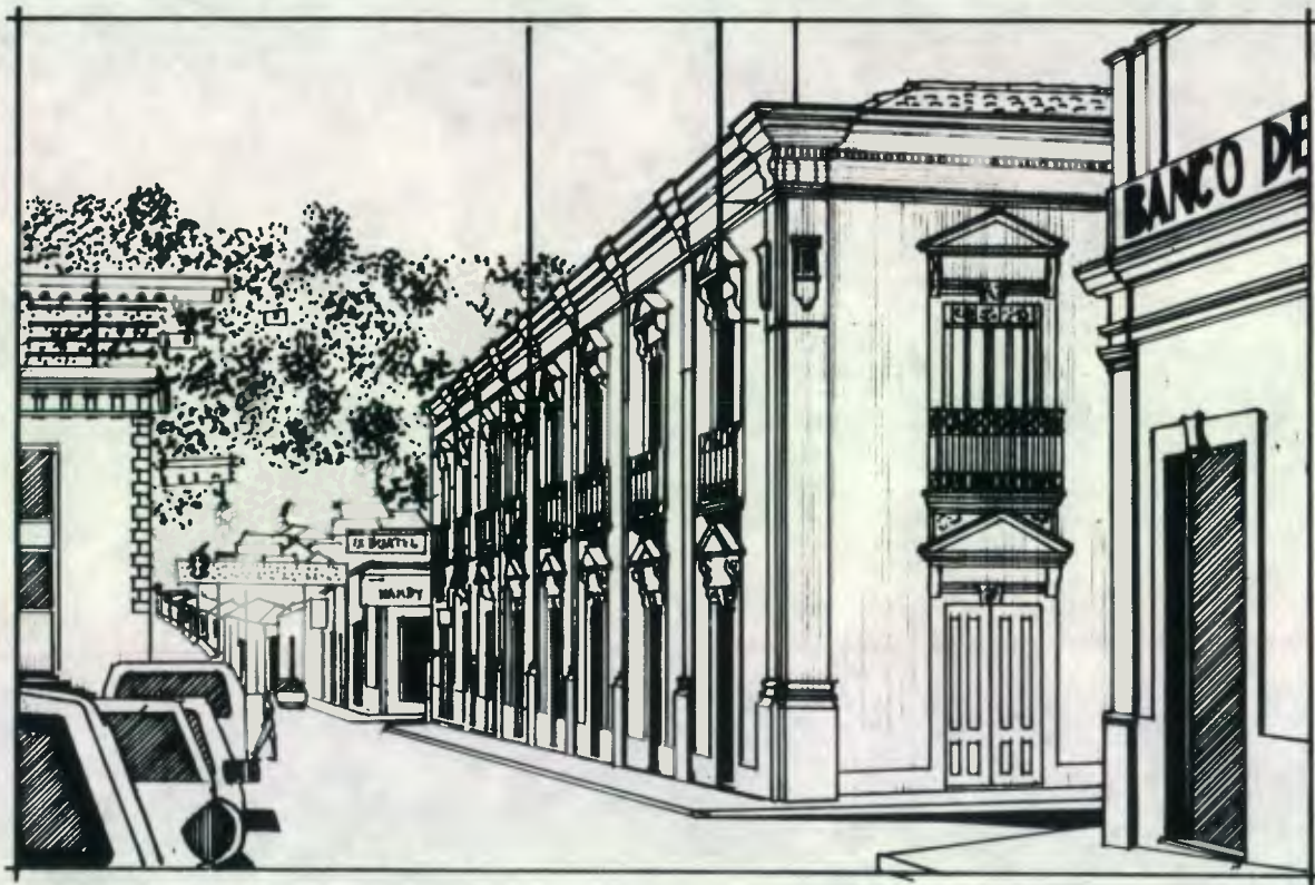
4 APUNTE. 12 AV. ENTRE 6ª. CALLE Y 11ª. CALLE. SOBRESALE EN TODA SU EXTENSIÓN EL ANTIGUO EDIFICIO DE GOBERNACIÓN. SU ESTILO PERTENECE AL LLAMADO NEOCLÁSICO, HACEN USO DE ELEMENTOS DE ORDEN TOSCANO CONSIDERADO UN DORICO SIMPLIFICADO COMO LAS PILASTRAS ADOSADAS AL MURO QUE POSEEN BASE, CAPITEL Y CORNISA
