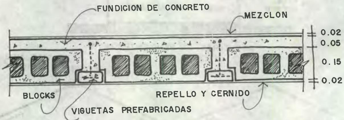
CUBIERTA PREFABRICADA DE VIGUETAS Y BLOCKS CON FUNDICION DE CONCRETO DE 5 cm. DE ESPESOR, MAS PANUELOS CON MEZCLON DE 2 cm. DE ESPESOR CON ACABADO DE REPELLO Y CERNIDO EN EL CIELO CON ESPESOR DE 2 cm.
