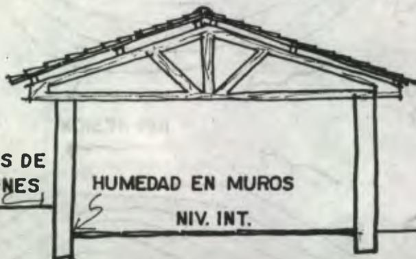
EVITAR CONSTRUCCIONES CON NIVELES INFERIORES A LOS EXTERIORES
