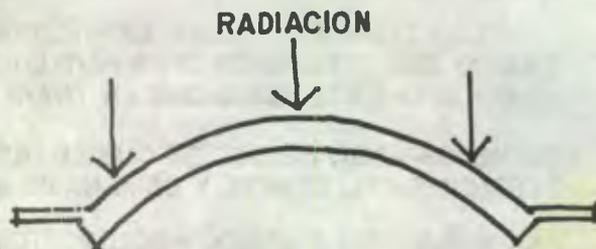
EN LOS TECHOS CURVOS ES MENOR EL CALOR POR CONDUCCION DEBIDO A QUE LA RADIACION SOLAR ES PERPENDICULAR A LA BOVEDA EN UN SOLO PUNTO
