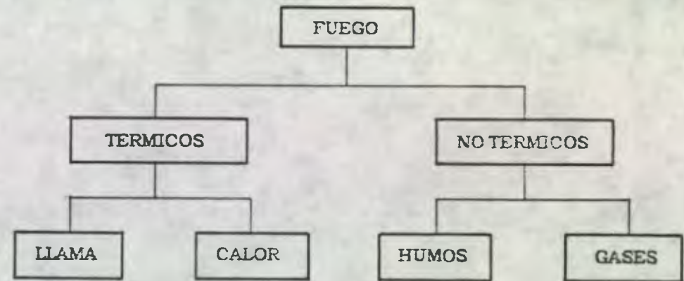
FIGURA III. REPRESENTACION ESQUEMATICA DE LOS PRODUCTOS DE LA COMBUSTION QUE INFLUYEN SOBRE EL PROYECTO DE EDIFICIO
