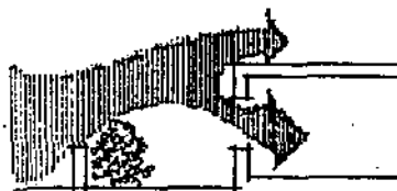
10 - ARBUSTOS Y OTRAS OBSTRUCCIONES EN EL EXTERIOR PUEDEN REDUCIR LAS CORRIENTES DE AIRE.
