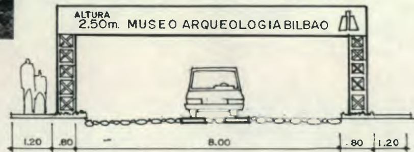
VIA SECUNDARIA, ACCESO CON ALTURA LIMITADA
