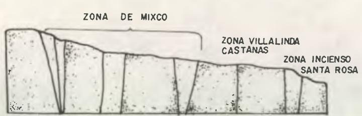
SECCION A-A' RUPTURAS EN LA ZONA DE LA FALLA DE MIXCO DURANTE EL EVENTO DE 1976
