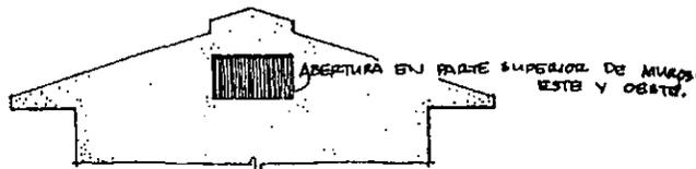
LAS ABERTURAS DICHOAS EN LA PARTE SUPERIOR DE LOS MUROS ESTE Y OESTE CONTRIBUYEN A MEJORAR LA VENTILACIÓN DE LA CÁMARA DE AIRE. ESTAS PUEDEN SER PALETAS INMÓVILES DE MADERA, BARROTES DE HIERRO, CELUSO, ETC. Y DEBERÁN PROTEGERSE DE LA PENETRACIÓN DE LA LLUVIA, LA RADIACIÓN SOLAR, ANIMALES E INSECTOS.
