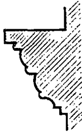
DETALLE 2 MOLDURAS EN BOVEDA (2) escala 1:5
