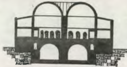
BOVEDA ANULAR SECCION
