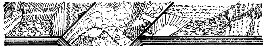
ALAMBRE ENTREPAPELADO EN LAS CAPAS DE PAPEL
