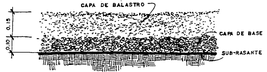
DETALLE SUPERFICIE BALASTRADA
