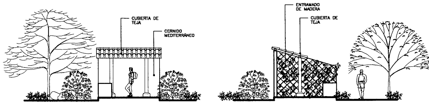
ELEVACIÓN FRONTAL DE MÓDULO DE CHURRASQUERAS ELEVACIÓN LATERAL DE MÓDULO DE CHURRASQUERAS
