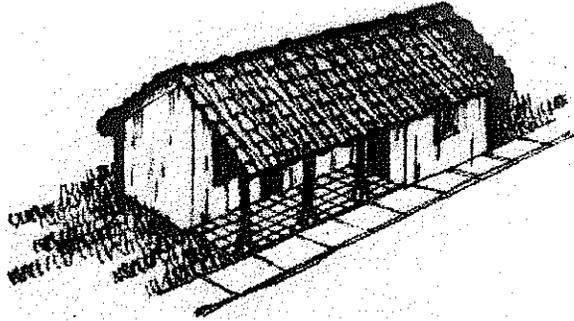
Esta es una de las viviendas típicas del Nor-Oriente del país, son casas sencillas construidas de adobe, madera y teja. Repelladas y muchas veces sólo pintadas con cal, de pisos de baldosa o de cemento líquido. Sus cubiertas están construidas con estructuras de palos rollizos y de teja, con un cielo falso de caña o de algún tipo de madera. La mayoría de veces esa estructura es tratada y pintada con cal para evitar el deterioro por polillas.
