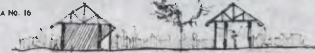
Protección del sol y la lluvia por medio de Voladizos, Techos salidos, Ventanas remetidas, etc.
