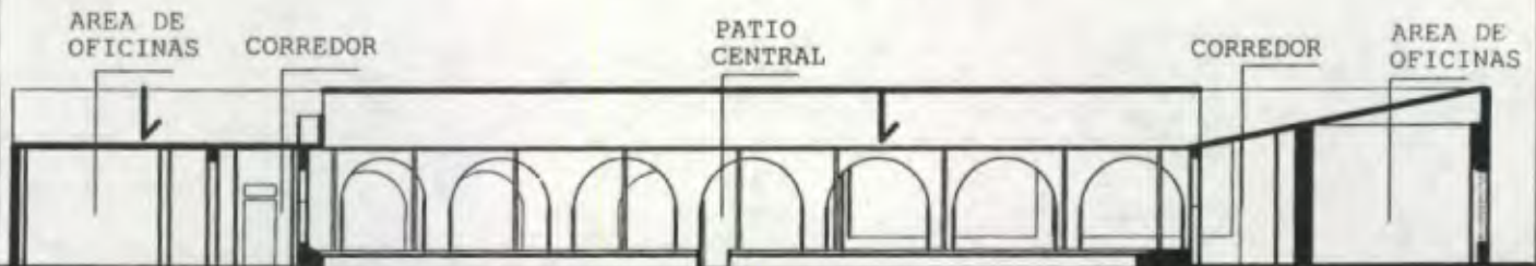
SECCION C-C' ESTADO ACTUAL Escala 1:250
