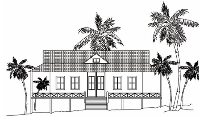
El nivel del piso de las edificaciones debe de quedar elevado para evitar las posibles inundaciones.
