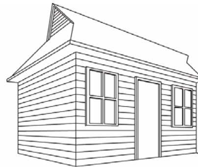
Aberturas en las cubiertas para permitir la circulación del viento.
