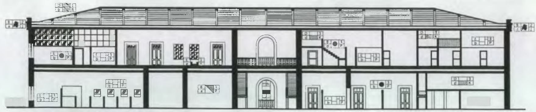
SECCION LONGITUDINAL ALTERACIONES Y DETERIOROS
