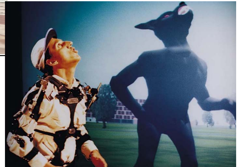
▲ Imagen 5: En los sistemas de RV en segunda persona, como el que se muestra en esta fotografía, de la compañía estadounidense “Sarcos” el usuario se ve proyectado en una pantalla de video permitiéndole interacción directa, en tiempo real con su entorno virtual.
