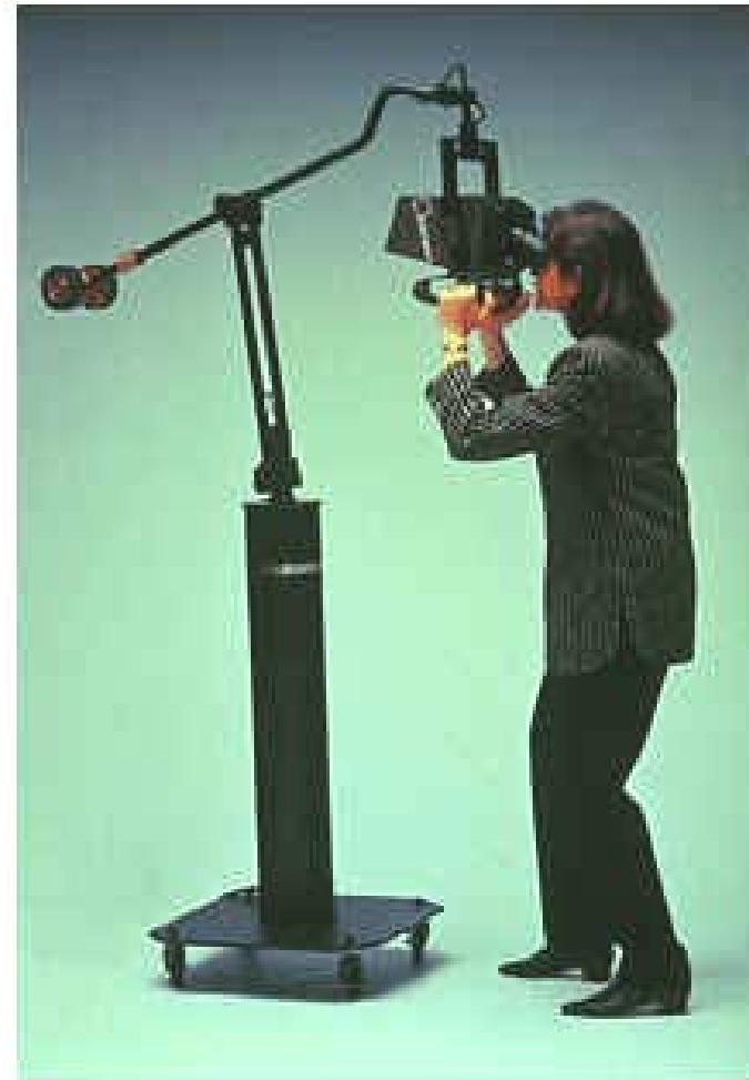
▲ Imagen 33: El despliegue de inmersión personal "Boom 3C" de la compañía "Fakespace", ofrece visualización estereoscópica, con una estructura cuyo soporte balanceado hace fácil su manejo. Tecnología CRT genera 1280 x 1024 píxeles por ojo para obtener detalles ricos de imágenes a color.
