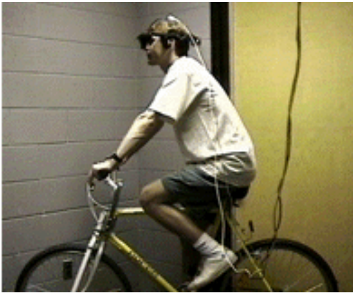
◀ Imagen 13: Para hacer recorridos en mundos virtuales extensos, se usan interfaces como la bicicleta, en donde el explorador puede dirigirla como si estuviera manejando en el “mundo real”, siendo todo de una forma estacionaria.
