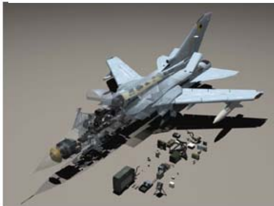
▲ Imagen 30: Aviación. Los estudiantes son capaces de remover y manipular unidades aviónicas y sujetarlas a diagnósticos reales para encontrar fallas provocadas por el supervisor del entrenamiento.
