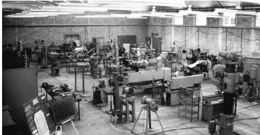
FOTOGRAFÍA 30: VISTA PANORÁMICA DEL TALLER DE TORNOS, EN ESTE SE FABRICAN PIEZAS DE ACERO Y OTROS METALES, LA MAQUINARIA CON QUE FUE EQUIPADO ESTE TALLER, DATA DESDE SU FUNDACIÓN EN 1959. POR LAS CARACTERÍSTICAS DE PESO Y FORMA DE LAS MISMAS AUN CONSERVAN SU POSICIÓN ORIGINAL PERO SIN FUNCIONAR ALGUNAS DE ELLAS.
