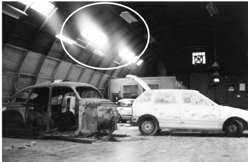
FOTOGRAFÍA 24: LA VENTILACIÓN NO ES ADECUADA AL TIPO DE TRABAJO. EN LA FOTOGRAFÍA SE OBSERVA LA ACUMULACIÓN DE PARTÍCULAS DE PINTURA Y GAS REFLEJADOS ALREDEDOR DE LAS ENTRADAS DE LUZ.
