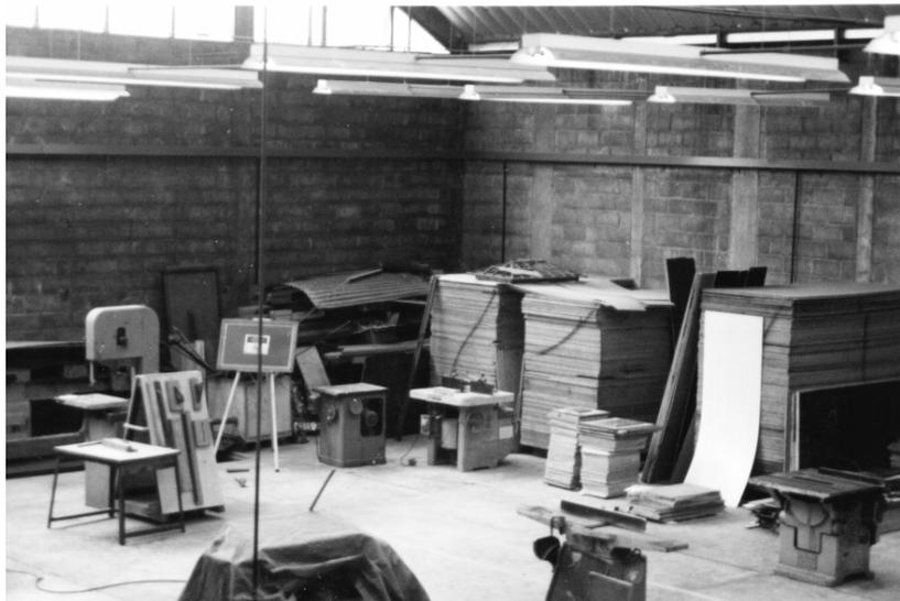
FOTOGRAFÍA 27: EN LOS TALLERES NO SE IMPLEMENTARON ÁREAS DE DESCARGA Y ALMACENAJE CON PROPORCIONES ADECUADAS, DEBIENDO COLOCAR EL MATERIAL DE TRABAJO EN ÁREAS DESTINADAS A OTRAS ACTIVIDADES.
