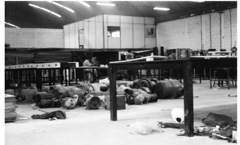
FOTOGRAFÍA 25: EN EL EXTREMO SUPERIOR IZQUIERDO SE APRECIA LA FALTA DE MUROS DE DIVISIÓN ENTRE UN TALLER Y OTRO, POR LO QUE EL RUIDO DE LAS MAQUINAS SE MEZCLA EN LOS TALLERES RUIDOSOS Y NO RUIDOSOS.
