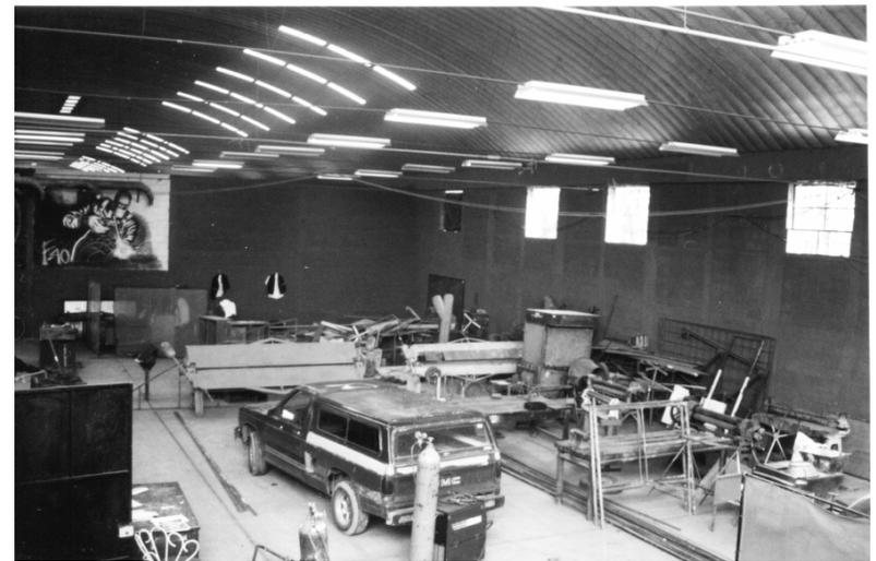
FOTOGRAFÍA 26: LA ILUMINACIÓN ARTIFICIAL EN GENERAL ES DEFICIENTE TOMANDO EN CUENTA LA ALTURA DE LAS LÁMPARAS Y EL NUMERO DE UNIDADES, ADEMÁS NO SE CUENTA CON ILUMINACIÓN ESPECIAL EN LOS PUESTOS DE TRABAJO.
