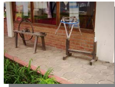
Foto 1: urdidora para enrollar canutos de hilo para los tejidos Autor: fotografía propia, oct. 2003
