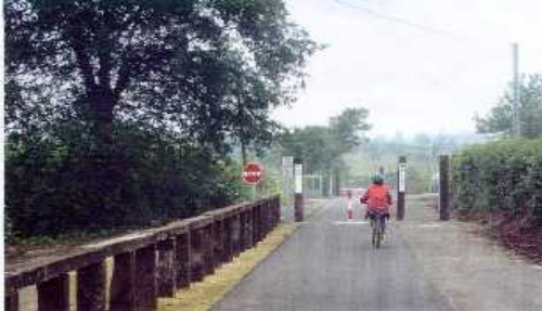
Foto 5 Señalización y restricciones al paso de vehículos a motor, en las intersecciones con otros viales. Fuente: http://www.aevv-egwa.org .
