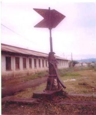
Foto 41. Switch para cambio de vía, ubicado a un costado del Taller de Mantenimiento, Estación Ipala. Fuente: Silvia Rosales, Octubre 2003.
