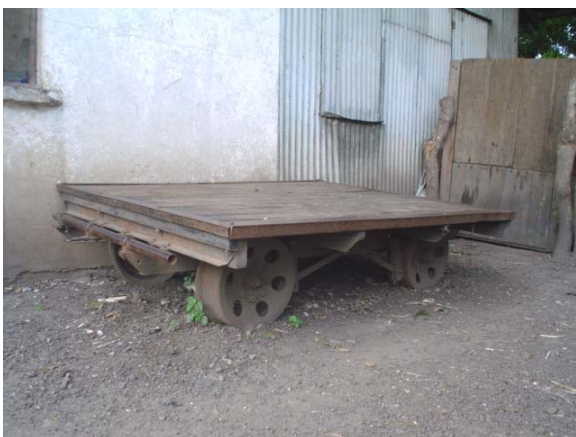
Foto 50. PushCar encontrado en Fachada Norte Casa de Caporales Segundos, patrimonio cultural en la Estación Ipala, fuente: César Mota, Octubre 2003.
