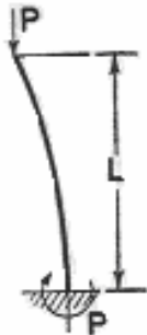
Columna empotrada por un extremo, con el otro extremo Libre para poder moverse en cualquier sentido (30)
