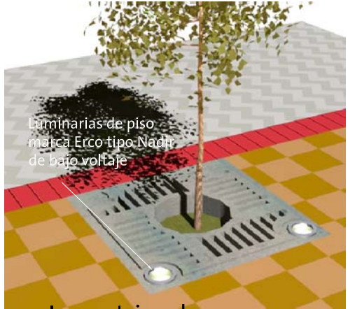
Isometrico de alcorque y arbol Proyecto de mejoramiento de imagen urbana Santander, Panajachel ESC.sin
