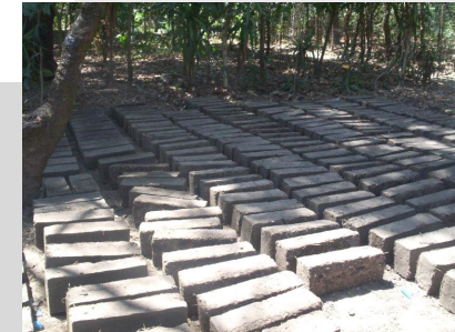
Adobe Secado al Sol San Marcos la Laguna
