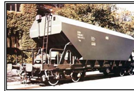
Foto # 20. Vagón tolva para transporte de granos, descarga inferior central por medio de dos compuertas deslizantes, compuerta de descarga a lo largo del techo accionada desde la plataforma y pasarela superior para acceso a la tolva. Preparado para recibir el enganche automático. Plano # 1. Elevación y Planta de un vagón contenedor de granos. Fuente www.todotrenes.com
