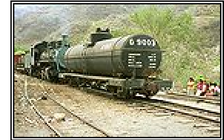
Fotos # 25 y 26. Tomas de contenedor cisterna montado sobre plataforma. Fuente: www.heinz-buehler.ch/guatemala/fequa.
