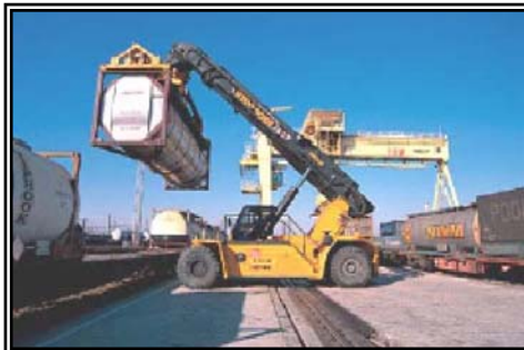
Fotos # 48, 49 y 50. Ejemplo del proceso de carga desde su origen hasta su destino. Muestran el proceso de carga y descarga de las unidades del transporte intermodal, en el primer caso contenedores cisterna, y en la 46 contenedor rectangular. Fuente: www.lenguajeintermodal.com .
