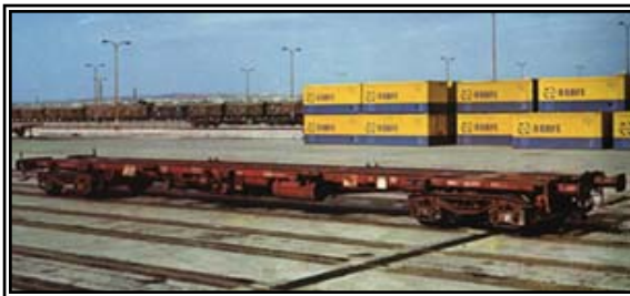
Foto # 24. Toma de una plataforma con piso para contenedores y mercancías especiales. Fuente www.todotrenes.com
