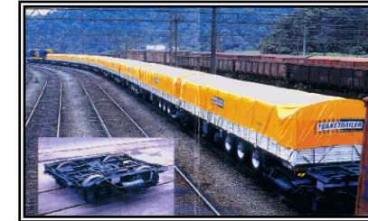
Fotos # 13 y 14. Muestran la unidad del transporte intermodal o UTI, la cual es el contenedor tanto en semiremolques como sobre plataformas de ferrocarril. Fuente: www.todotrenes.com
