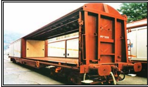
Foto # 23. Modelo deslizante. Un sistema de palancas y árboles, superior e inferior, para cada pared deslizante permite la apertura, inmovilización y cierre con los dispositivos de seguridad para evitar falsas maniobras. Fuente www.todotrenes.com
