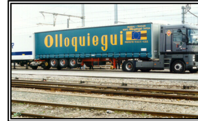
Fotos # 13 y 14. Muestran la unidad del transporte intermodal o UTI, la cual es el contenedor tanto en semiremolques como sobre plataformas de ferrocarril. Fuente: www.todotrenes.com
