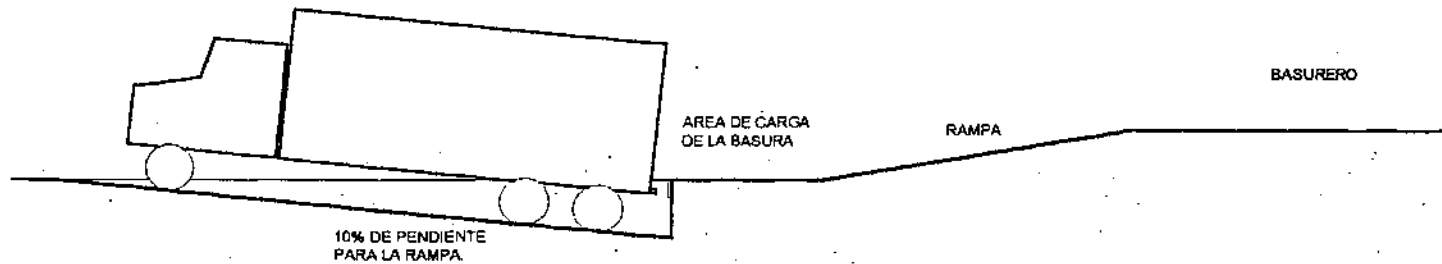
ELEVACION ESCALA 1:75 RAMPA PARA BASURERO
