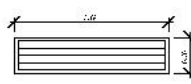
V-6 VENTANA TIPO V-6 CON LA MITAD DE VIDRIO FIJO Y LA MITAD DE VIDRIO DE PALETA, DIVIDIDA EN CUATRO ESTAS VENTANAS LLEVARÁN BARRAS DE HIERRO EN LA PARTE EXTERIOR DE LAS MISMAS TODAS.
