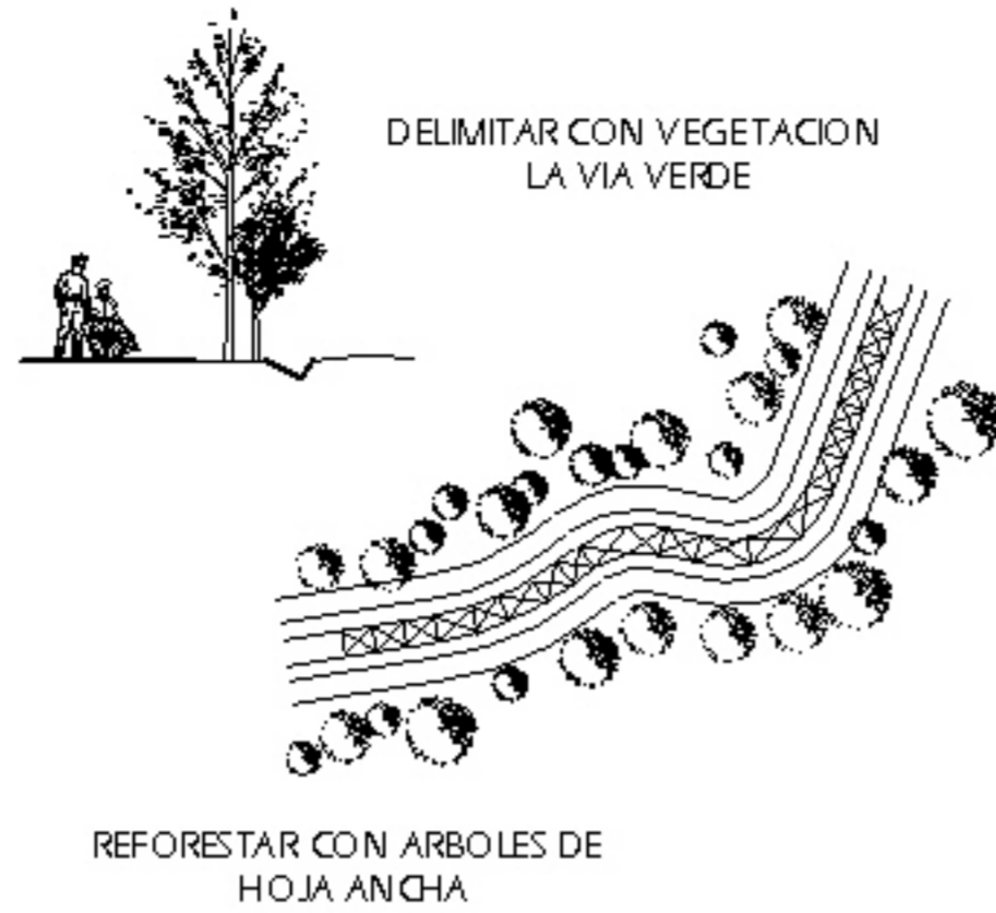
BANDAS DE CIRCULACION PEATONAL Y DE VEHICULOS NOMOTORIZADOS CONSTRUIDA DE BALASTRE.
