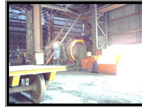
Fotografía 5, Segundo Horno de Afinamiento, en este se analiza la calidad del acero y se modifica, si es necesario.
