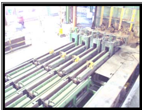
Fotografía 8, Máquina Cortadora en donde los lingotes pasan a tener una Medida estándar.
