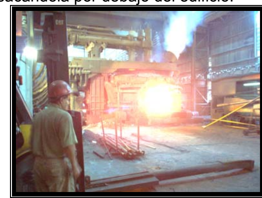
Fotografía 3, Primer Horno (Horno Eléctrico de Arco) para refinado de acero.
