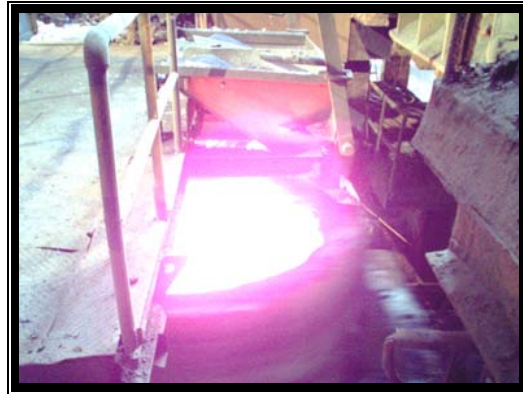
Fotografía 4, Observamos el Carrito en forma de olla para verter el Acero líquido, hecha de ladrillo refractario.
