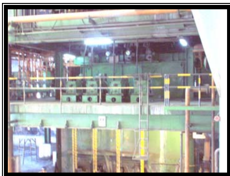
Fotografía 7, Máquina de Colada, en esta se observan los 4 moldes de Cobre para verter el acero líquido del segundo Horno.
