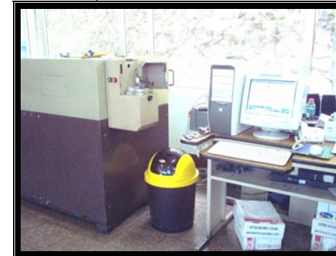
Fotografía 6, Equipo de Laboratorio utilizado para analizar las muestras que llegan del segundo horno, por medio de conductos de succión.
