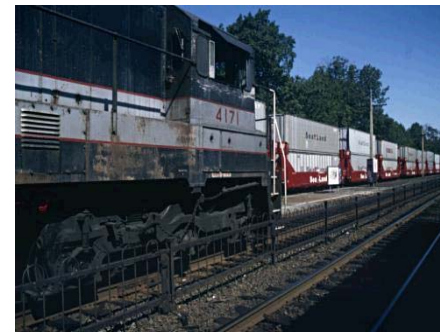
Fotografía No. 9 Transporte de contenedores en un mercancías Los trenes de mercancías transportan carbón, cereal, mineral, ganado, líquidos, alimentos y otras mercancías. Las mercancías se suelen empaquetar y embalar en grandes contenedores cerrados. Durante el trayecto viajan apilados sobre un vagón de plataforma. Enciclopedia Microsoft © Encarta © 2004
