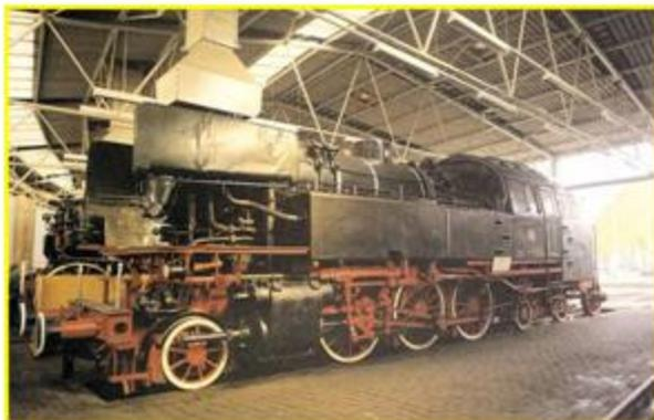
Fotografía No. 73. Uno de los últimos diseños de Deutsche Bundesbahn fue la Serie 66, unas máquinas 2-6-4T representadas en Bochum por la n° 002. Estas locomotoras de dos cilindros de vapor recalentado eran una amalgama de los principios de diseño de las prusianas, de las alemanas del sur y de las de los ferrocarriles estatales, utilizando los últimos avances en soldadura y termotecnología.
