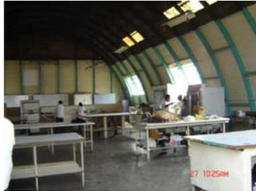
Foto 11. El material de los muros no es el adecuado para las actividades que se realizan allí, ya que provoca que se encierre mucho calor.
