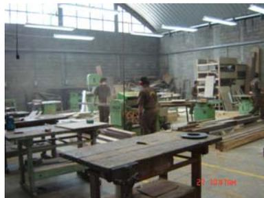
Foto 8. Se puede observar en la fotografía que por falta de una bodega para guardar la madera se deja dentro del taller lo que provoca que el espacio para práctica se reduzca.
