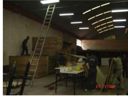
Foto 3 y 4. Se observa que no existe suficiente iluminación y ventilación en este taller, lo que provoca que se encierre el calor por la actividad que allí se realiza.
