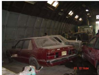
Foto 9 y 10. El taller de enderezado y pintura no cuenta con una cabina para pintura ni un área iluminada para enderezado por lo que normalmente se realizan estas actividades fuera del taller, lo cual afecta el trabajo debido al clima (viento, sol, lluvia, etc.).
