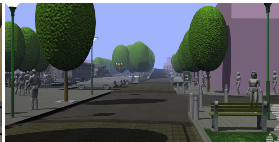
Imagen 24. Avenida del Ferrocarril, ubicados a un costado de la plaza sur, donde se puede apreciar que hay tramos de la avenida que han sido texturizados con adoquines, y también se aprecia el tratamiento dado a los cruces y bocacalles. Nótese la franja de mobiliario que genera la alameda, separa a las circulaciones peatonales y a las calles haciendo a las banquetas más seguras para el peatón.
