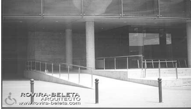
Fotografía No. 11. Extraído de un edificio español, podemos observar la creación de una rampa como parte de la fachada integrando los espacios exteriores e interiores facilitando el acceso a todos. Fuente: www.rovirabeletas.com . 2005.
