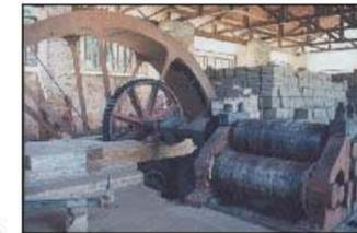
Foto 20: Rueda hidráulica con prensadora de caña del trapiche.
