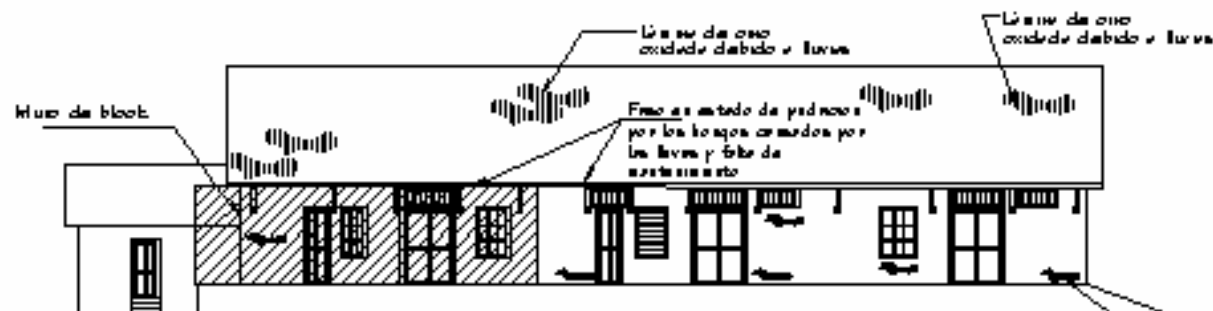
ELEVACION FRONTAL daños y alteraciones
