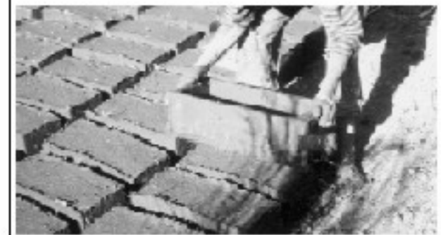
7-2 Proceso de elaboración de adobes en Ecuador
