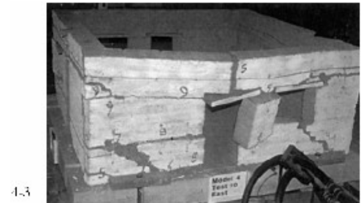
4-1 a 4-3 Grietas típicas producidas por impactos sísmicos simulados en modelos (Tolles et al. 2000)
