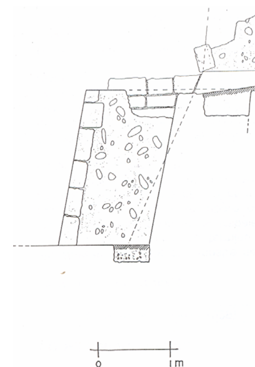
Fig. 21. Detalle de un muro de contención construido con piedra caliza canteada Nakum. (PRONAT)
