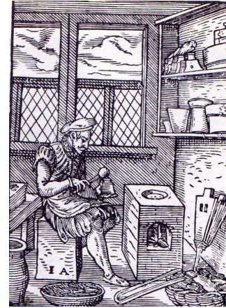
fig.12 El fundidor de tipos es dibujado vertiendo el plomo derretido en el molde del tipo para fundir una letra. Frente a él, el cesto está lleno de nuevos tipos fundidos.
