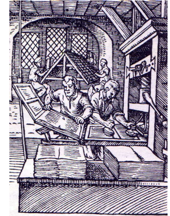
fig.13 Un impresor es mostrado retirando una nueva hoja impresa de la prensa, mientras el otro entinta el tipo. En el fondo se ven los cajistas colocando tipos en las cajas de tipos.
