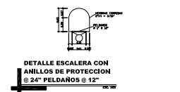
DETALLE ESCALERA CON ANILLOS DE PROTECCION @ 24" Peldaños @ 12"
